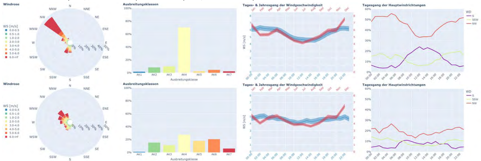
Abb. 104 Gemessene (oben, 10m über Grund) und simulierte (unten, 25m über Grund) Windverhältnisse
